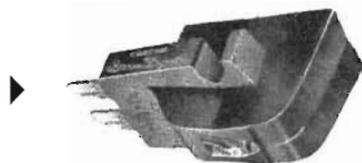
**Audio Dynamic ADC-1** - Testina magnetica con fortissima compiacenza ( $20 \times 10^{-6}$ ) e ridottissimo peso di lettura (da 0,75 a 1,5 grammi) adatta solo per giradischi e bracci professionali • Risposta  $\pm 2$  db da 10 a 20.000 cps • Diafonia 30 db • Uscita 7 mV • Punta diamante 0,6 mm • Ottima schermatura.
