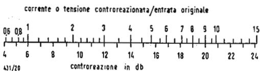
▲ Fig. 8 - Scala ausiliaria per calcolare la resistenza di controreazione per mezzo della relazione tra l'entrata interna e la componente controreazionata.
