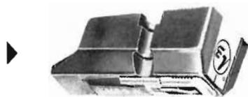
**Shure M7 D Stereo Dynetic** - Tipo magnetico con punta diamante 0,7 mm • Risposta  $20 \pm 15.000$  cps • Diafonia 20 db a 1.000 cps • Uscita 5 mV su 47 Kohm • Compiacenza  $3,5 - 10^{-6}$  • Peso di lettura 4-7 grammi • Buona schermatura.
