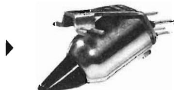
**CARATTERISTICHE TECNICHE:** Responso  $\pm 3$  db da 30 a 15.000 cps • Uscita: 7 mV per canale a 5 cm/sec - 1000 cps • Diafonia: migliore di 20 db • Peso di lettura: da 2 a 4 grammi • Compiacenza:  $5 \times 10^{-6}$  dyne sia orizz. che verticale • Massa mobile: meno di 3 mg • Carico ottimo: 47.000 ohm o più • Puntina: 0,7 mil diamanti • Schermatura: in mumital, efficacissima.
