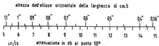
▲ Fig. 7 - Scala ausiliaria per determinare dalla traccia dell'oscillografo l'attenuazione al punto 90 gradi.
